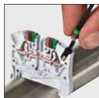
Automatické pripojenie pevného vodiča alebo pleteného vodiča s dutinkou zasunutím – na všetky svorky do šírky 6 mm
