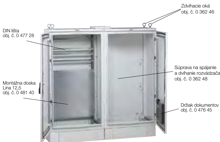
Příklad zostavy 2 rozvádzačov obj. č. 0 362 85 na podstavci obj. č. 0 362 96
